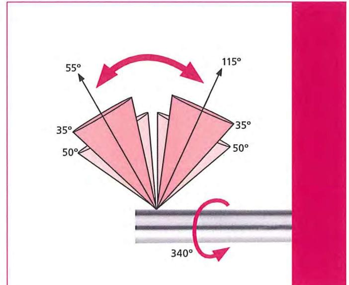
**Blickrichtungen und Sichtfelder eines Schwenk-Prisma-Endoskopes sind variabel**
